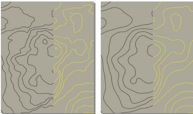
Bild 4. Anpassning av höjdkurvor mellan kartblad. Till höger mjuka kurvor och till vänster obearbetade kurvor.
