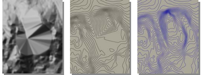
Bild 2. Problem vid markfiltrering. Terrängskuggning och höjdkurvor från originaldata till vänster. Till höger resultatet efter lokal förbättring.
